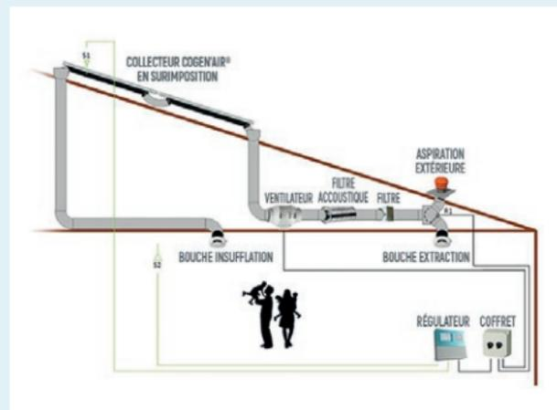
Fonctionnement de l'installation posée sous toit.
